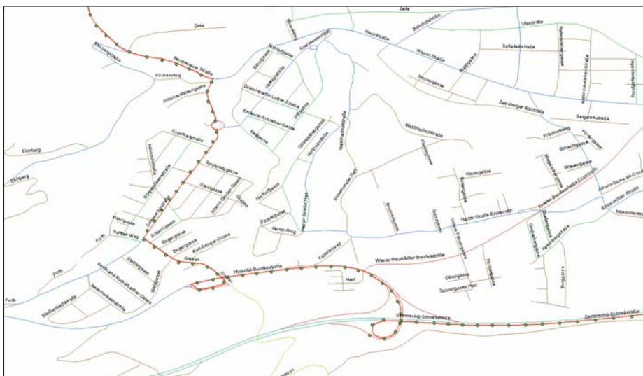
Výsledok procesu priradenia do mapy (zelené body = GPS lokačné body, červená čiara = výsledok priradenia do mapy).
